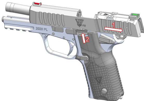
Rys. 3.2. Zatrzymanie zamka w tylnym położeniu.
