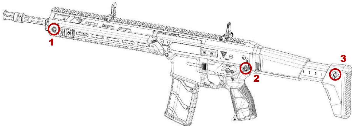
Rys. 24. Punkty montażowe pasa nośnego: 1 – na łożu, 2 – na komorze spustowej, 3 – na kolbie
