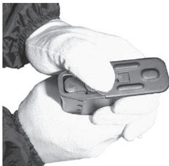
Rys. 76. Odłączanie dna magazynka
