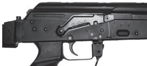
Rys. 101. Położenie dźwigni bezpiecznika w stanie zabezpieczonym
