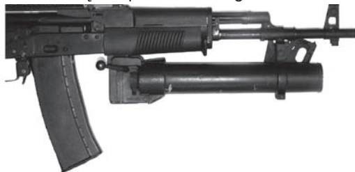
Rys. 108. Granatnik Pallad podłączony do karabinu
