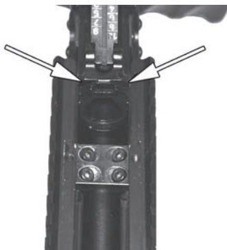
Rys. 97. Łoże z szynami – montaż zacisku wraz z łożem do karabinu
