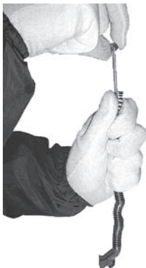
Rys. 78. Odłączanie opory sprężyny powrotnej
