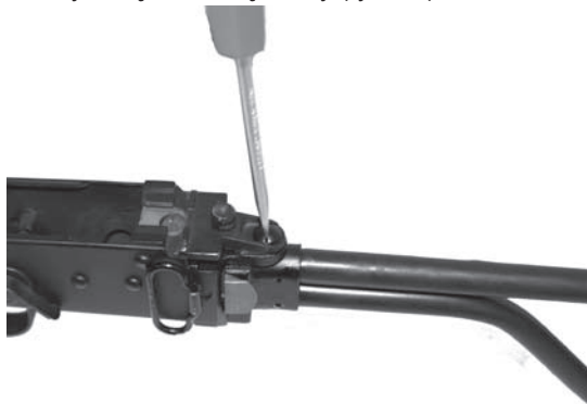
Rys. 82. Demontaż kolby składanej
