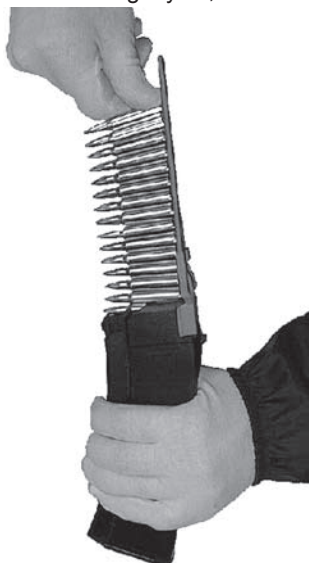
Rys. 25. Ładowanie magazynka za pomocą łódek
