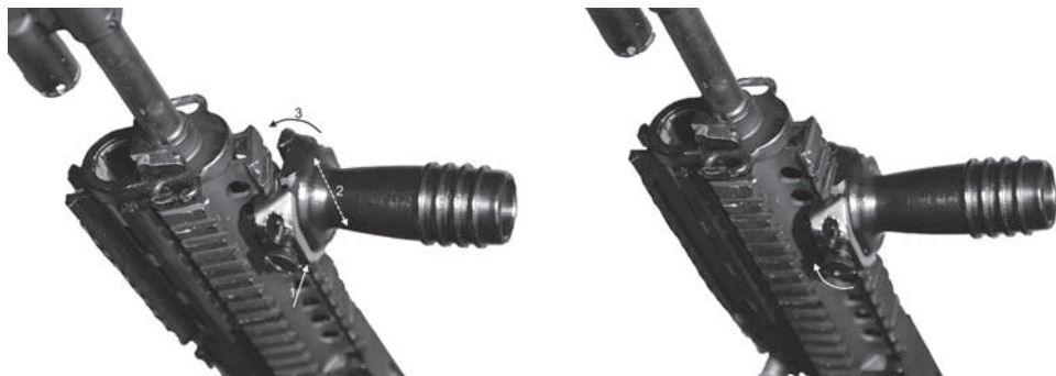
Rys. 34. Chwyć przedni odłączalny – montaż do karabinu
