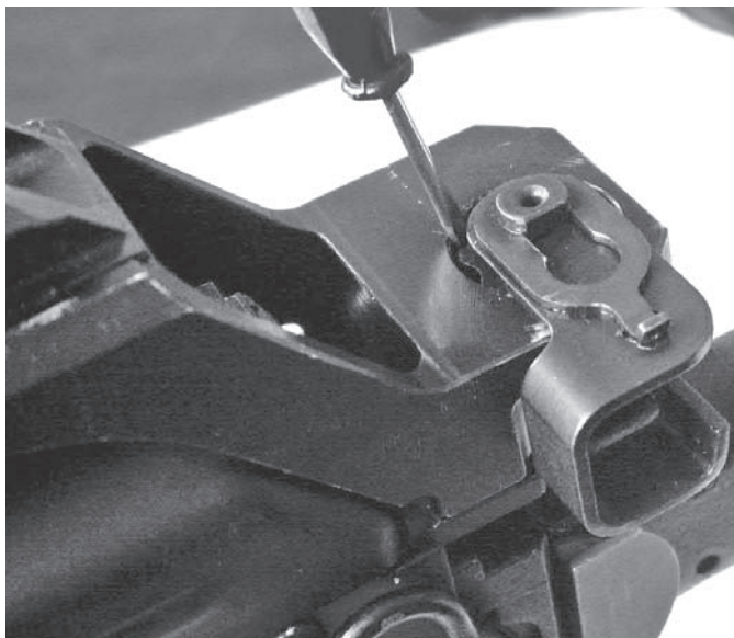
Rys. 38. Zatrzask mimośrodowy w pozycji otwartej – regulacja nakrętki specjalnej zacisku
