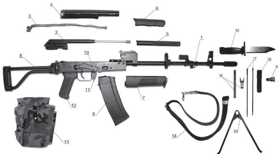
Rys. 1. a - Widok ogólny 5,56 mm karabinu szturmowego – wariant A; b - Zasadnicze części i zespoły karabinu: 1- komora zamkowa z lufą; 2-suwadło z zamkiem; 3-urządzenie powrotne; 4-pokrywa komory zamkowej; 5-rura gazowa; 6-nakładka; 7-łożo; 8-kolba z osadą; 9-magazynek; 10-bezpiecznik; 11-zatrząsk magazynka; 12-rękojeść; 13-torba na magazynki; 14-pas do broni strzeleckiej; 15-bagnet; 16-łódka z nasadką; 17-wycior; 18-przybornik z przyborami; 19-odrzutnik do ślepego strzelania; 20-dwójnóg.
