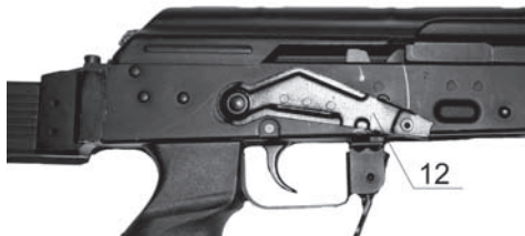
Rys. 100. Położenie dźwigni bezpiecznika w stanie odbezpieczonym
