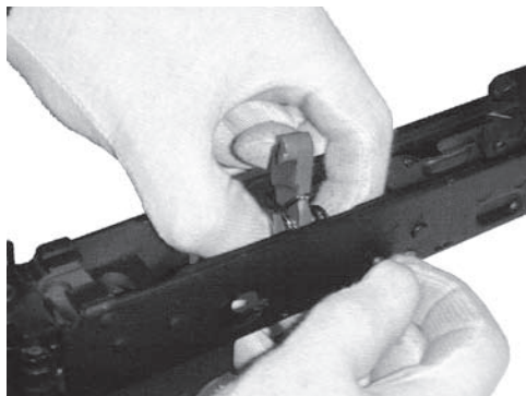
Rys. 89. Wkładanie kurka do komory zamkowej
