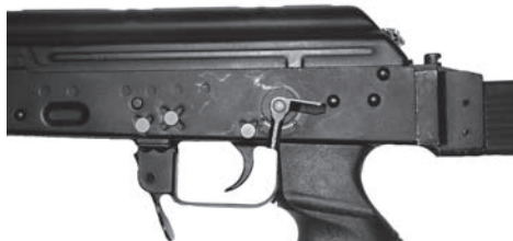
Rys. 103. Położenie przełącznika rodzaju ognia w pozycji P (ogień pojedynczy)
