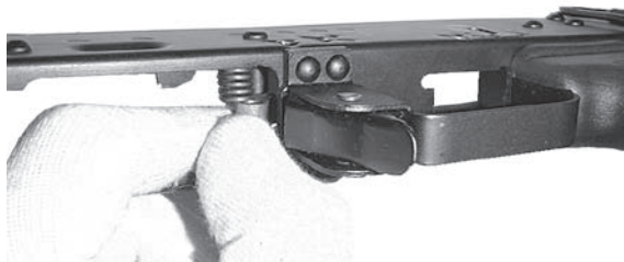
Rys. 80. Wymywanie spustu samoczynnego ze sprężyną z komory zamkowej
