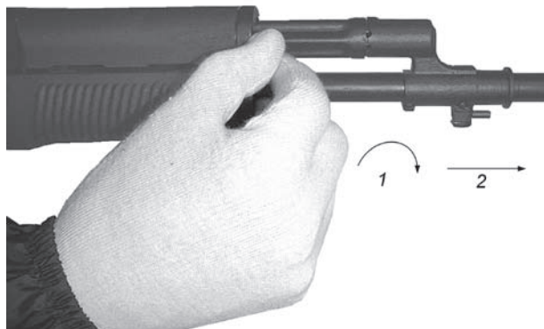
Rys. 74. Odłączanie łoża, nakładki i rury gazowej
