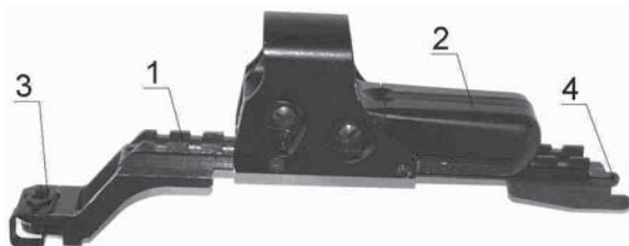
Rys. 35. Szyna celownicza szybkoodłączalna z zamontowanym celownikiem optoelektronicznym: 1-szyna szybko-odłączalna, 2-celownik optoelektroniczny, 3-zatrzask mimośrodowy, 4-kły ustalające szynę w podstawie celownika
