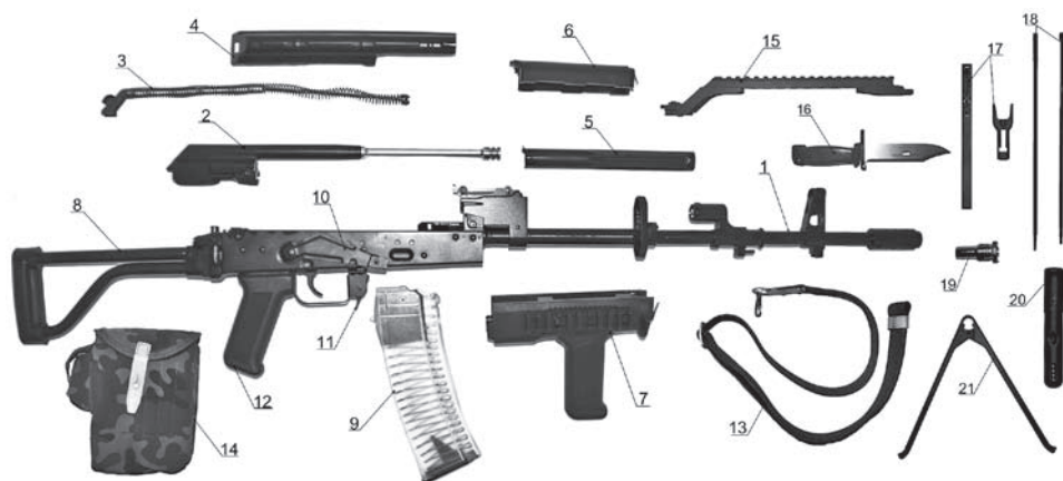
Rys. 2. a - Widok ogólny 5,56 mm karabinu szturmowego – wariant B; b - Zasadnicze części i zespoły karabinu: 1- komora zamkowa z lufą; 2-suwadło z zamkiem; 3-urządzenie powrotne; 4-pokrywa komory zamkowej; 5-rura gazowa; 6-nakładka; 7-zsp. łoża z chwytem i dwoma szynami bocznymi; 8-kolba z osadą; 9-magazynek przezroczysty 30-nb; 10-bezpiecznik; 11-zatrzask magazynka; 12-rękojeść; 13-pas do broni strzeleckiej; 14-torba na magazynki; 15-zsp. szyny celowniczej szybkoodłączalnej; 16-bagnet; 17- łódka z nasadką; 18-wycior; 19-odrzutnik do ślepego strzelania; 20-przyborek z przyborami 21-dwójnóg.
