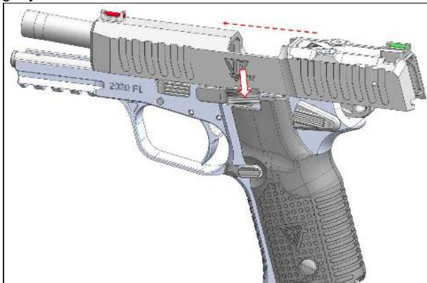
Rys. 3.5. Zwalnianie zamka / wprowadzanie naboju.
