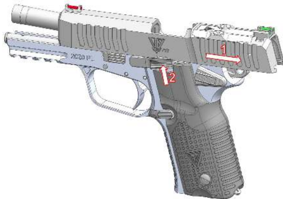
Rys. 3.2. Zatrzymanie zamka w tylnym położeniu.
