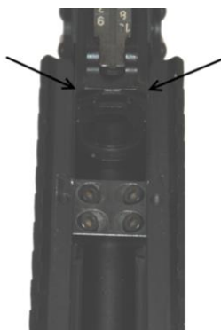
Rys.97 Łoże z szynami – montaż zacisku wraz z łożem do karabinu
