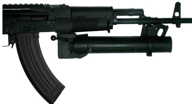
Rys. 107. Granatnik Pallad podłączony do karabinka
