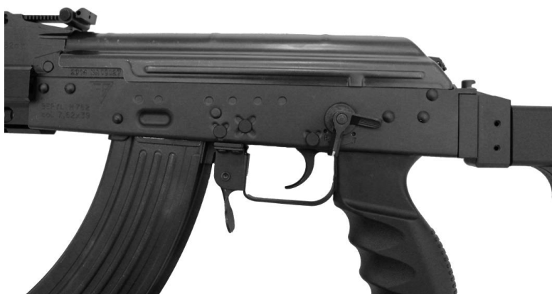
Rys. 103. Położenie przełącznika rodzaju ognia w pozycji 1 (ogień pojedynczy)
