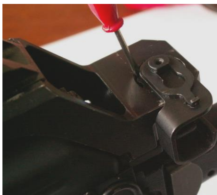
Rys.38 Zatrask mimośrodowy w pozycji otwartej – regulacja nakrętki specjalnej zacisku
