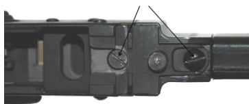
Rys.86 Montaż kolby – zabezpieczanie wkrętów preparatem Loctite 243
