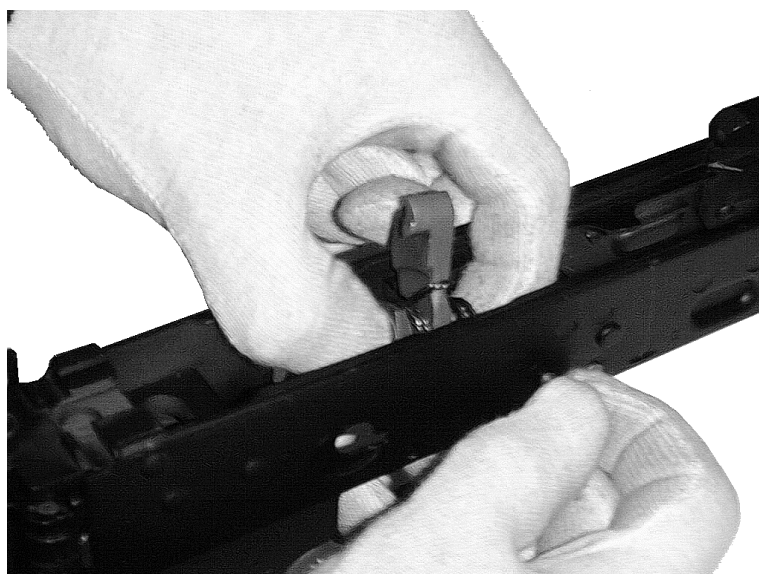
Rys. 89. Wkładanie kurka do komory zamkowej
