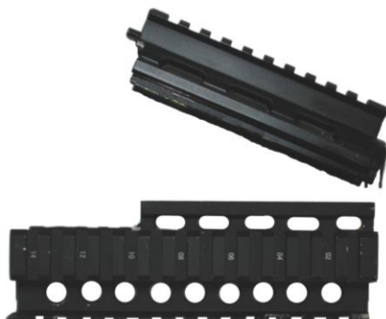
Rys.32 Zintegrowany zespół łoża z nakładką z szynami – odłączanie łoża od nakładki
