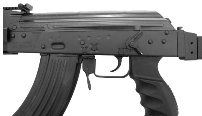
Rys. 104. Położenie przełącznika rodzaju ognia w pozycji T (ogień seryjny)
