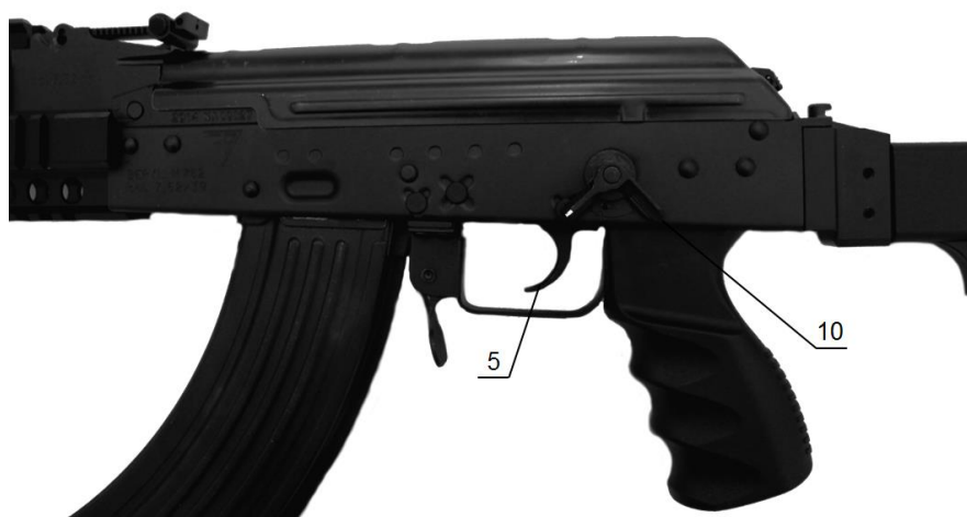
Rys. 102. Położenie przełącznika rodzaju ognia w pozycji R (ogień ciągły)
