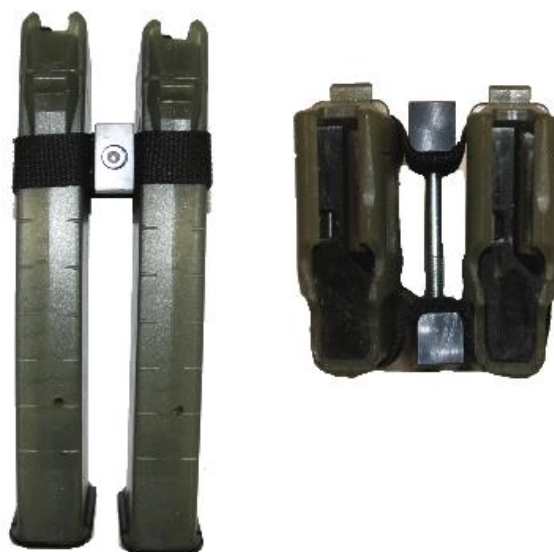
Rys.28 Klipsy do łączenia magazynków – kolejny etap montażu na magazynkach – wstępne skręcenie klipsów
