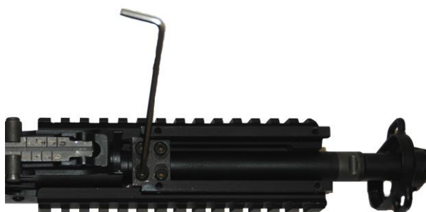
Rys.77 Demontaż zintegrowanego zespołu łoża z nakładką z szynami – odkręcanie wkrętów
