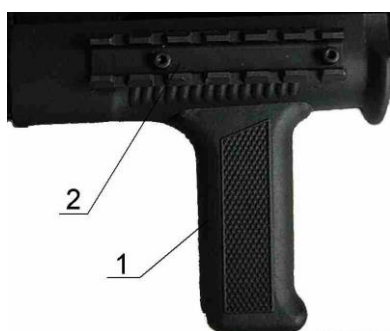
Rys. 31. Łoże z pionowym chwytem i dwoma szynami bocznymi: 1-chwyty pionowy; 2-szyna boczna
