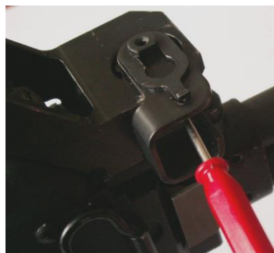
Rys.37 Zatrask mimośrodowy w pozycji otwartej - wykręcanie wkrętu dociskowego
